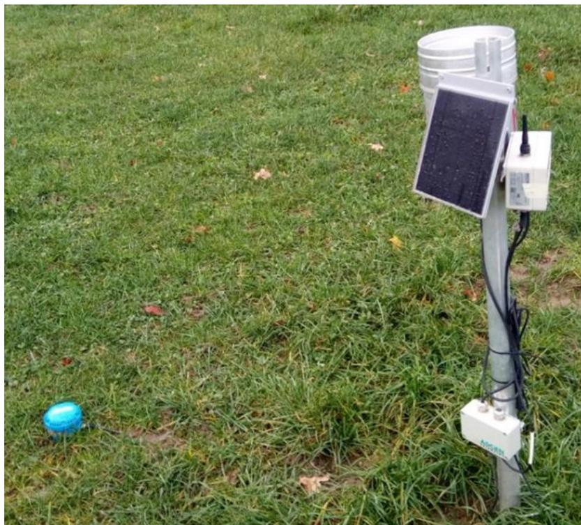
Figure 11 : A droite de l'image, la station avec le pluviomètre et le panneau solaire. A gauche, la sonde hygrométrique avec le capuchon bleu, enfoncé dans le sol à une profondeur de 60 cm (photo prise le 2.12.2018).
