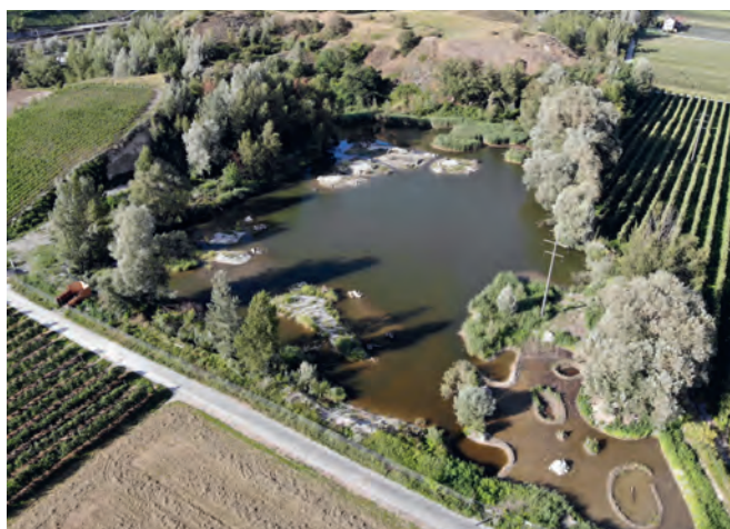
Figure 11: Travaux terminés avec création de hauts-fonds, plan d'eau, pierriers et tas de bois mort hors des hautes-eaux, vue de drone en hautes-eaux [05.07.2022]
